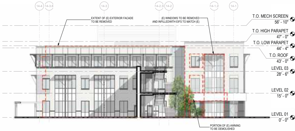
3 MPK 14 ATRIUM ELEVATION - EXISTING
