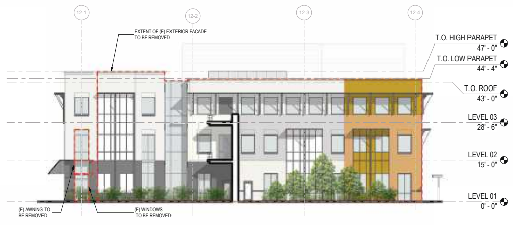
1 MPK 12 ATRIUM ELEVATION - EXISTING
